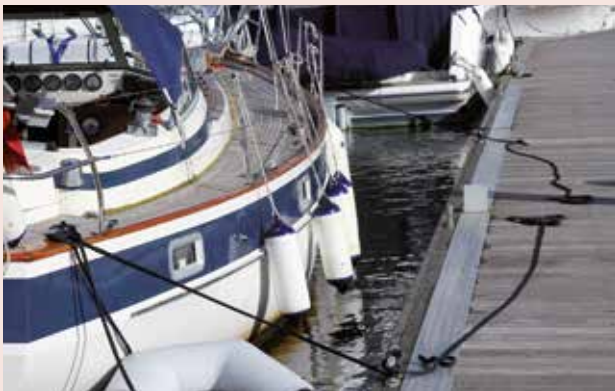
Het anker pakt en je trekt de boot bij de steiger of de kademuur vandaan.
