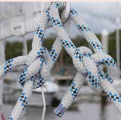
Als ik mijn fokkensloten met een paalsteek aan het schootoog bevestig, doe ik dat zo dat de gladde kant van de paalsteek naar de stagen wijst. Dan blijven ze minder snel haken.
