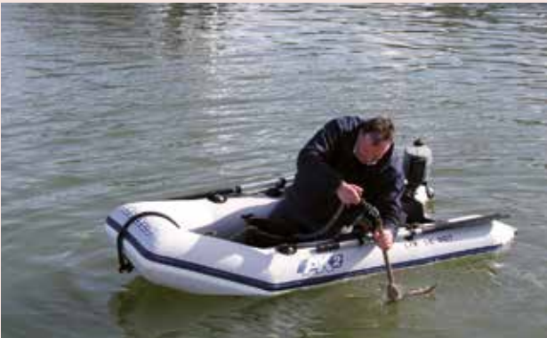
Leg het werpanker met ketting en lijn in een emmer, vaar met de bijboot een geschikte afstand van je boot weg en laat het anker vallen.
