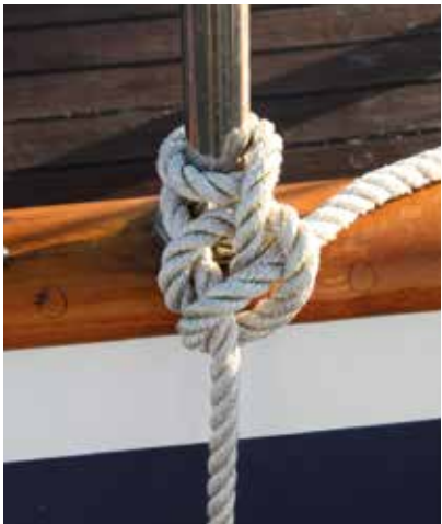
Stootwil aan de voet van een scepter met een rondtorn en twee halve steken
