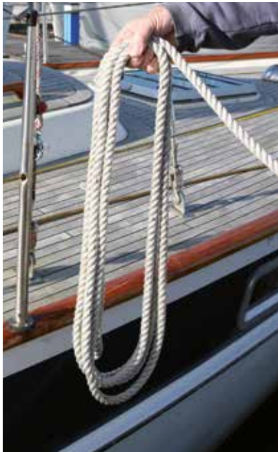
Schiet de lijn met de klok mee op; houd de slagen even lang
