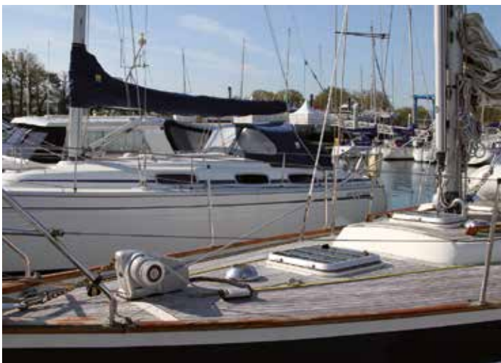
▲ Dat werkt omdat hij horizontaal staat. Met een verticale ankerlier kan het ook, maar als de lier in een ankerbak zit lukt het niet, omdat de grootzeilval van de lier op de mast naar de ankerlier moet lopen en door de hoek die de val dan met sommige ankerlieren maakt slipt hij eraf.
