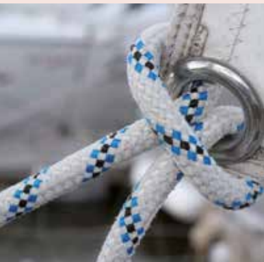
Je kunt ook één lange schoot nemen en hem vastzetten met een koesteek. Die slipt niet en nu is er nog minder kans dat hij in het want blijft hangen.
