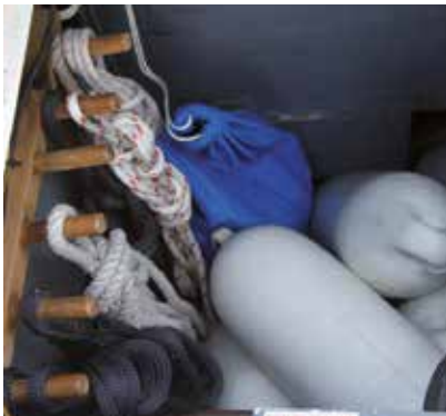
Hier is een rek in een bakskist gemaakt om lijnen aan te hangen. Dat is een goed idee, omdat vocht uit de lijnen zo in de bilge drupt. Het is ook veel netter dan wanneer alle lijnen boven op elkaar in de bakskist liggen.
