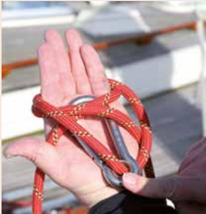
Neem nu de nieuwe bovenste slag (wat eerst slag 2 was) met de karabijnhaak, trek hem over de twee andere slagen heen en haal hem achterlangs weer omhoog.
