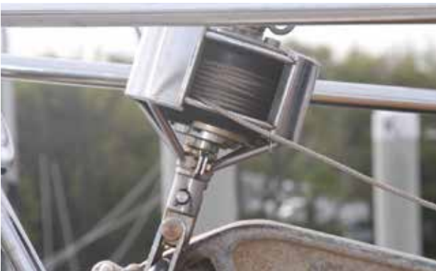
▲ Zorg er als je het voorzeil aan het rolreefsysteem vastmaakt voor dat de trommel genoeg ruimte heeft voor alle lijn, of lijn/ staaldraadcombinatie als het zeil uitgerold wordt
